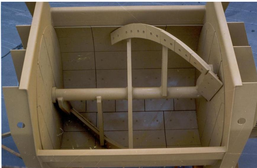
**PALE DI MESCOLAZIONE IN HARDOX®500** ad elevatissima durezza e resistenza all'usura .
